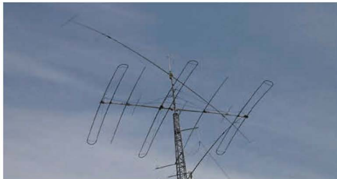
↑39mHのタワーのトップには全長25.8mの1.8/1.9MHzロータリーダイポール。その下には遠くからもよく見えるマルチバンド(3.5~50MHz)5エレ八木Stepp IR DB42を設置。その下のStepp IR、4エレヤギとはスタックにできる。
