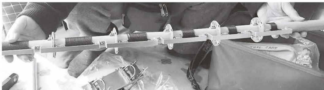
↑写真2 / MFJ-1797のトップ近くのエレメント。ここに短縮コイルを配した、トップローディング式。
