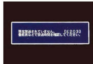
↑写真3 / テレビ受信波に対し430MHzの基本波の影響が大きくなるとブラック画面になってしまう。
