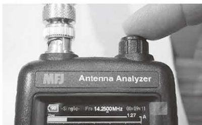
↑写真5 / 「Freq: 周波数」で回転ノブを1回押すと、小数点の位が上がる。
