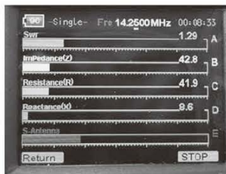
↑写真4 / 測定する周波数は、「Freq: 周波数」で、回転ノブを利用して設定する。
