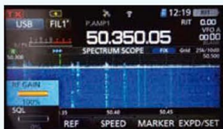
↑写真9／調整する機会が多いAFゲインはAF/RF/SQLボリュームで調整する。RFゲインやスケルチレベルは、ボリュームをプッシュすると液晶ディスプレイ画面に表示される「RF GAIN」と「SQL」のボタンを選択し、ボリュームで調整することができます。
