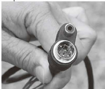
↑フレキシブルマイクコード接続ジャック。RCA側にはフレキシブルマイク、8Pin側は無線機に接続する。
