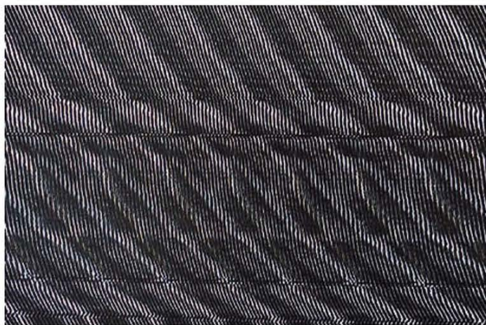
↑写真1/ アナログ・テレビ時代の代表的なTVI。ひどいときには縞模様の画像となってしまった。
