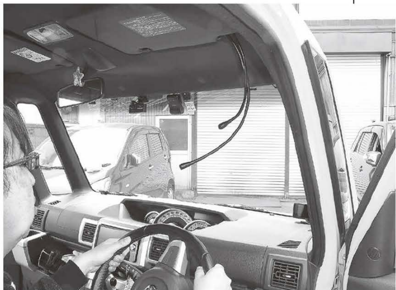
↑標準タイプ標準タイプとロングタイプの長さを比較。乗用車用の標準タイプだと口元までの距離が遠く明瞭度に欠けてしまうので、今回はロングタイプを使用した。
