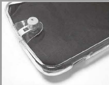
↑写真9/スマホのスピーカー部分にマイクを置き、スマホからの音声を拾う。
