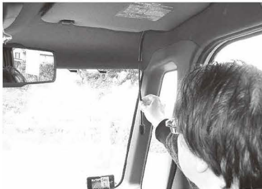
←フレキシブルマイクを使用しない時は、サイドビラー側に合わせて曲げておくと、運転の邪魔にならない。
