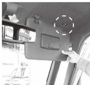
↑運転席側サンバイザーを固定してある右上のネジに、フレキシブルマイクを共締めして設置をする。
