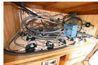
↑無数のアンテナを設置しているため、アンテナ切り替え機もこのような数に。回り込みを防ぐためフェライトコアを多数取り付けられている。
