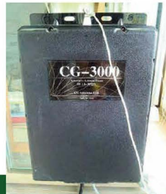
↓写真7/釣竿アンテナは、オートアンテナチューナーCG-3000に接続して利用。
