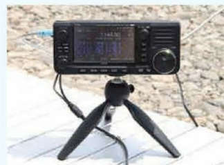
↑写真6/底面には三脚取り付け用の1/4インチのネジ穴があり、屋外でのオペレーションには小型の写真用三脚に設置するとよさそう(三脚は付属していない)。
