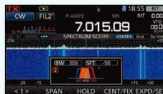
↑写真18 / ツインパスバンドチューニング (TWIN PBT) 機能はTWIN PBTダイヤルをプッシュし、トグル操作で切り替わる「PBT1」と「PBT2」の2つのフィルターのシフト量を調整して通過帯域幅と位置を調整する。
