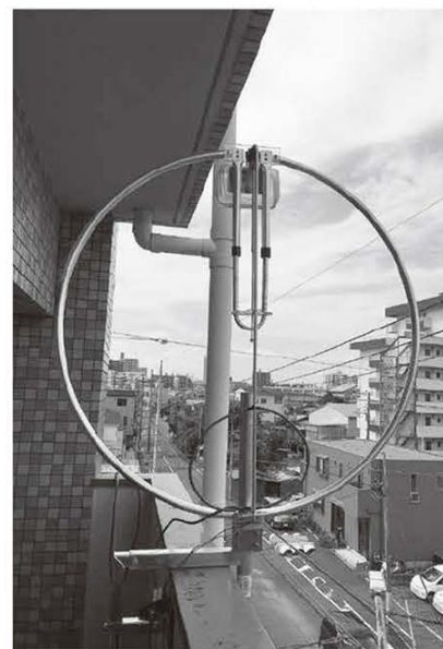
↑写真5 / BS・CS用のアンテナを取り付けるために手すりを挟んで固定する金具を使ってMLAをベランダ手すりに取り付けた。
