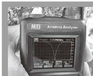
↑写真14 / 7MHz帯でのSWRを計測。V字型に下がっている。
