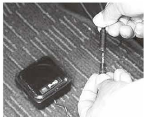
↑アドニスP-8iから出ているφ3.5mmジャックにスピーカーケーブルを接続する。これで外部スピーカーから受信音が聴こえる。
