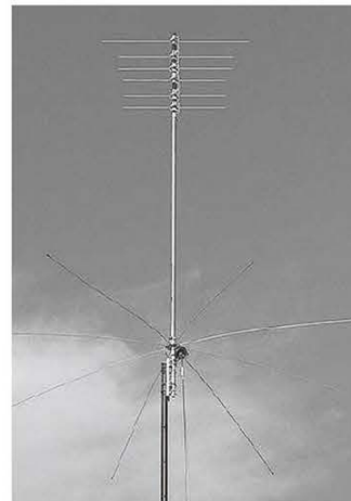
↑写真16 / MFJ-1797と比べ全長が短くコンパクトなMFJ-1797LP。設置場所が狭い場合、こちらを選択するのも手だ。
