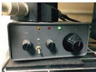
↑写真2/無線機とPCを繋ぐUSBインターフェイス (関西SSTV愛好会のコントロール局J13URSさんに譲っていただいた)。無線機切替機能も搭載している。
