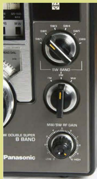
↑バンド切り替えスイッチは2つ搭載され、下がFM/SW/MW(中波)の切り替え用、上がSWバンド切り替え用(SW1～SW6)となっている。一番下のツマミはMW/SWのRFゲイン(感度)調整用。
