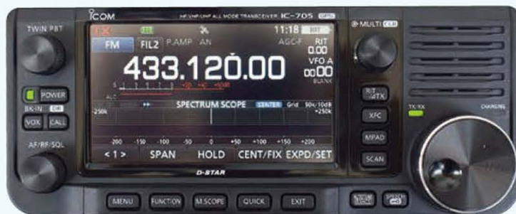
↑写真2/パネル面はIC-7300と同様の大きさの4.3インチの大型液晶ディスプレイを使用し、メインダイヤルとボリューム・プッシュスイッチが機能的に配置されている。
