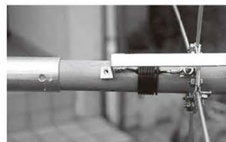
↑写真12 / 上部エレメントとキャパシティーハット部の接合部分。ネジ穴を揃え、ボルト締め。
