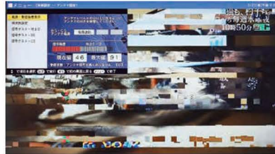
↑写真6 / テレビの受信レベル表示が430MHz帯の影響を受けないときは91だったものが、受信ブースター内の感度抑圧で46まで落ち、さらに混変調によりブロック・ノイズが発生している。
