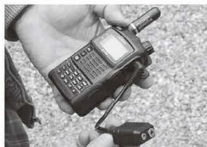
↑アドニスP-8iを接続するため、ヤエスFT1XDのマイク端子に純正オプションのCT-44 (税込1100円) を接続。
