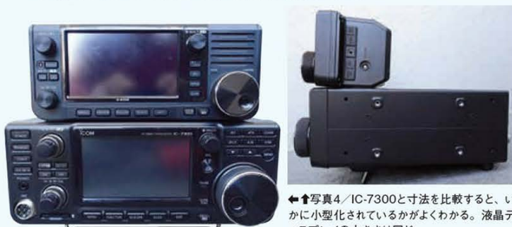
↑写真2/パネル面はIC-7300と同様の大きさの4.3インチの大型液晶ディスプレイを使用し、メインダイヤルとボリューム・プッシュスイッチが機能的に配置されている。
