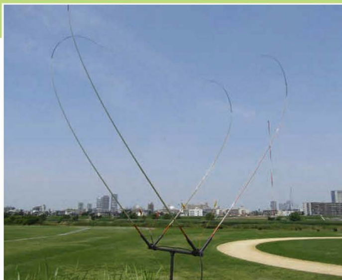
↑初心者でも簡単に作れる優れ物！面倒なバランとマッチング部が不要で八木アンテナより高利得！嬉しい自作の一品となります。
