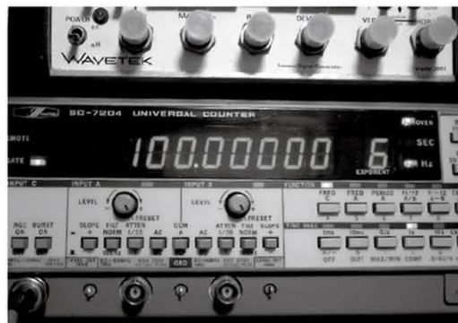
↑写真6 / Nano VNAのCHOを出力信号発生器とCW設定にし、信号発生装置として利用したものを周波数カウンターで測定。
