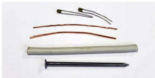
↓写真14/主要部品無償プレゼントの内容。上から、セラミックコンデンサー3pF、 \phi 0.8mmホルマル線、 \phi 1.2mm裸銅線、4CFB同軸、丸釘75mm。
