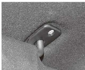
↑サンバイザーを固定してあるネジ。このネジを利用して固定する。取り外す際はネジをなくさないように注意。
