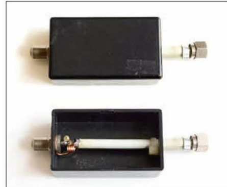
↑写真10 / 自作の430MHz帯トラップ・フィルタでも共振点で30dB以上の減衰特性を確保できる。
