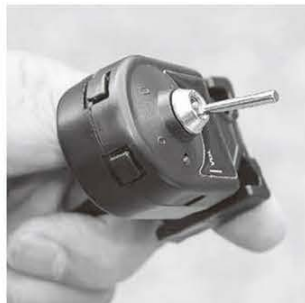
↑PTTスイッチに加え、周波数やメモリーをアップダウンできるコントロールスイッチ。PTTはトグルスイッチ式だ。
