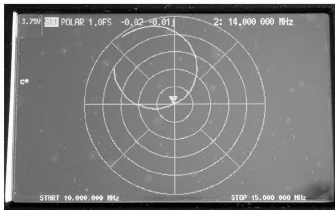
↑写真2 / Nano VNAで極座標表示した画面。
