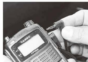
↑マイク端子と電源コードを接続。車から電源を取らないと、フレキシブルマイクの電源がONにならないので注意。
