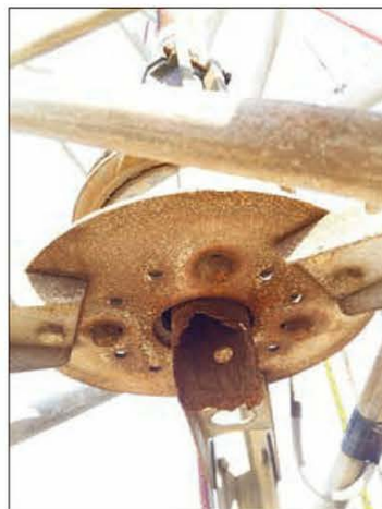
↑写真2／サビが進み、部品が破損している状態。
