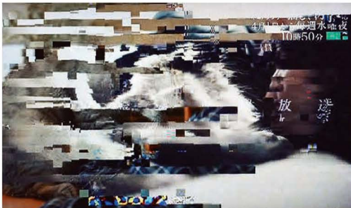
↑写真2 / テレビ受信ブースターに430MHzの基本波が混入して混変調を起こし、ブロック・ノイズが発生。テレビの誤り訂正符号化処理によって一部の画像は復調されるので、まだらなブロック・ノイズの画面になる。
