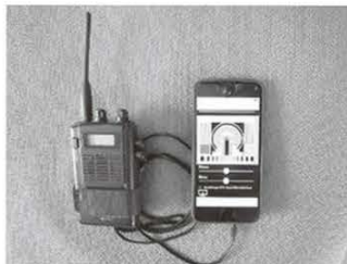
写真3 / 無線機とスマホを接続。音声ラインで接続している。
