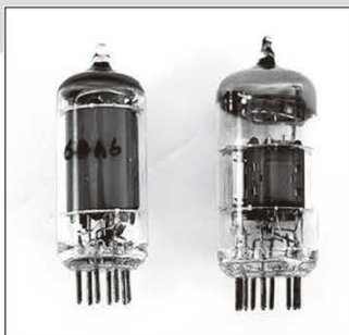
↑写真2/使用した真空管 (左から6BA6、6U8)
