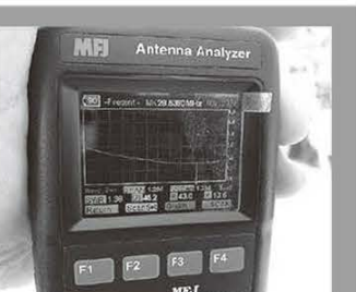
↑写真15 / 28MHz帯でのSWRを計測。広範囲でSWRが下がっている。
