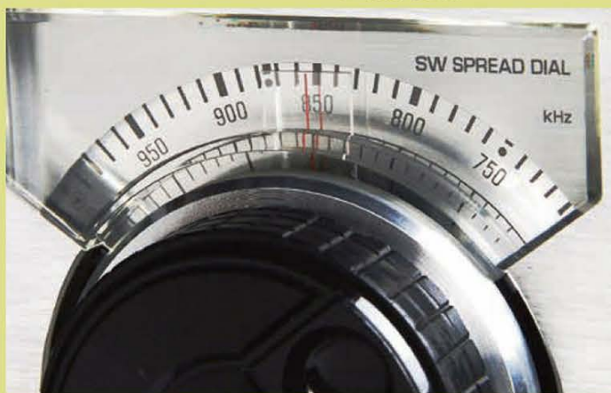
↑チューニングダイヤルには、10kHz単位の目盛りが付けられている。本機では、この目盛り部分を「スプレッドダイヤル」と称している。マーカー発信で校正することで、10kHz単位の周波数合わせが可能(目盛りと目盛りの中間に合わせることができるので、実質は5kHz単位の直読が可能)。
