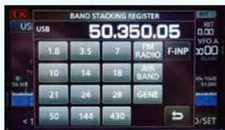
↑写真7／液晶ディスプレイ画面の周波数をワンタッチすれば、周波数バンドの選択画面が表示される。FM放送やエアバンドもプリセットされている。
