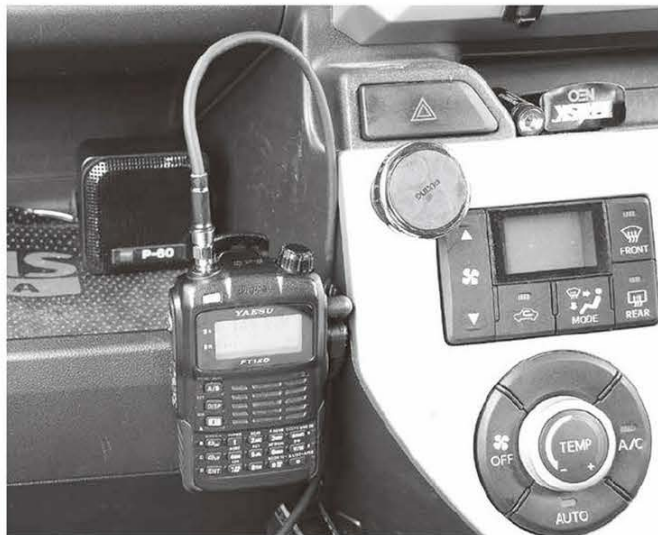
↑ヤエスFT1XDをグローブボックスに設置。スピーカーマイクを使わず、外部スピーカーとフレキシブルマイクの使用で、取り回しを気にせず安心して運用ができる。
