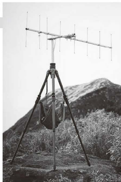
↑デジタル簡易無線のセパレート運用例、受信は八木アンテナ。
