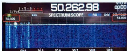
↑写真14 / 50MHz SSBバンドの表示画面で周波数幅は50.3-51.0MHz。ウォーターフォールを見ると、交信相手局は50.3-50.5MHzの低い周波数バンドにかたまっていることがわかる。
