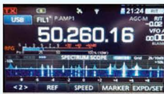
↑写真12／バンドの状況はリアルタイムスペクトラムスコープで確認できる。スペクトラム表示に必要な機能は液晶ディスプレイの下部にある2ページの5つの液晶タッチボタンで切り換えることができる。
