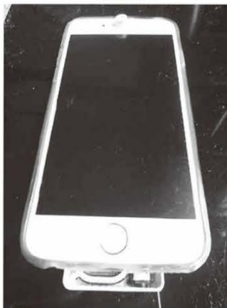
写真5 / iPhoneの表面。スピーカー部にマイクを配置。
