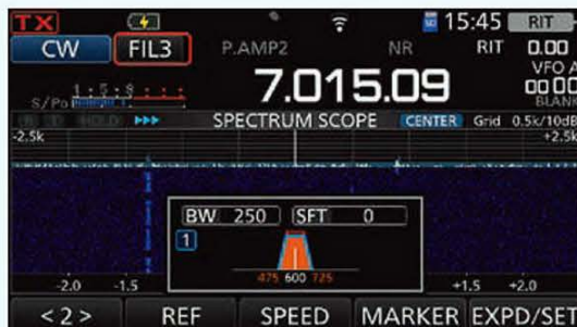
↑写真16 / デジタルIFフィルターが装備され、液晶ディスプレイのFILをワンタッチすれば、3種類のプリセットした帯域のIFフィルターをトグル切換で選択することができる。
