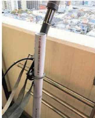
↑写真9 / ホームセンターで売っている塩ビのパイプを使って基台を設置している。
