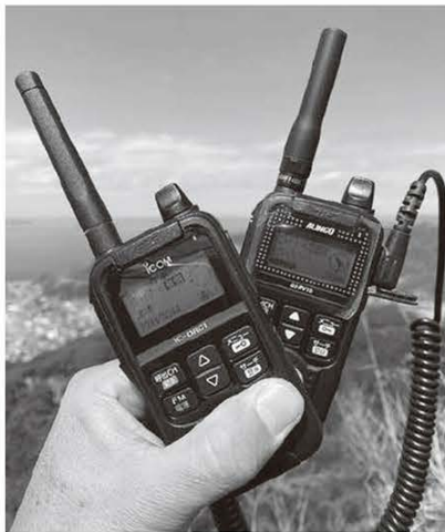
↑100km以上は「遠い」表示になるIC-DRC1と、「110km」と表示されたDJ-PV1D。Sメーターもうれしい!
