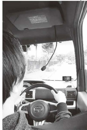
↑ヤエスFT1XDをグローブボックスに設置。スピーカーマイクを使わず、外部スピーカーとフレキシブルマイクの使用で、取り回しを気にせず安心して運用ができる。
