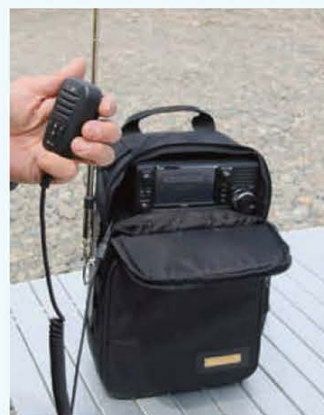
↑写真5/移動してのフィールド運用のためにアンテナ固定やケーブル穴など工夫された専用のマルチバックLC-192が用意されている。
