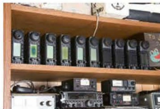
↑IC-706とIC-7000が計10台並んでいる。これは各バンドのコンディション確認用。PCと接続し、外部からモニターできるようになっている。(1.8/1.9~50MHzの10バンド) FT8使用。
