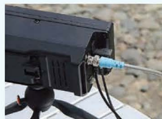
↑写真3/コネクター類はBNCアンテナ端子・マイク/スピーカ端子およびマイクロUSBメモリスロットが左側側面、コントロール端子類は右側側面に振り分けられており、背面は、リチウムイオンバッテリーが取り付け付く構造。
