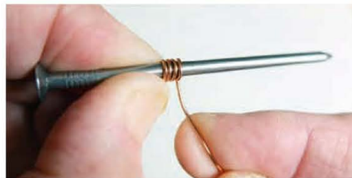
↓写真13/75mm長・ \phi 3.4mmの丸釘を使い、 \phi 0.8mmのホルマル線を巻くと再現性よく外計5mmのコイルを作ることができる。
