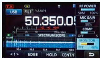
↑写真10／SSBで調整が必要な機能は、右側のマルチファンクションメニューで調整する。SSBモードを選択した状態でマルチファンクションダイヤルをプッシュするとSSBモードで調整が必要なRFパワー・MICゲイン・コンプレッサーレベル・モニターレベルが表示されて調整することができる。
