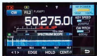
↑写真11／CWで調整が必要な機能は、右側のマルチファンクションメニューで調整する。CWモードを選択した状態でマルチファンクションダイヤルをプッシュするとCWで調整が必要なRFパワー・KEYスピード・CWピッチが表示されて調整することができる。
