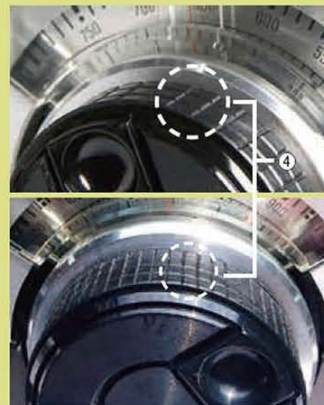
↑④チューニングダイヤルの加工が異なるバージョンも存在する。上の写真のダイヤルは外側の凹凸が3列になっているが、下の写真では凹凸が4列になっている
