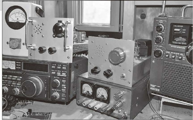
↑写真7/ 完成した2球ストレートラジオ (写真中央上)。
