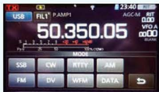
↑写真8／液晶ディスプレイ画面の「SSB」や「CW」と表示されている部分をタッチすれば、電波モード選択の画面が表示される。
