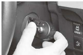
↑ハンドル右側の近い位置にPTTコントロールスイッチがあるため、操作しやすい。手元を見なくても操作できる。
