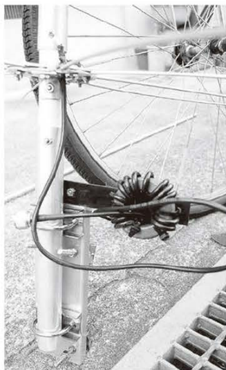
↑写真10 / ベース部が組みあがったところ。コアは金具にタイラップで固定する。
