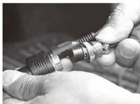
↑フレキシブルマイクコード接続ジャックのRCAにフレキシブルマイクを接続、8PinMIC端子にアドニスP-8iを接続する。
