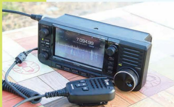
↑写真1/IC-705の寸法は幅20cm×高さ8.35cm×奥行8.2cm。ブロックのような形状をしていて重量は約1.1kg、片手で持てる。
